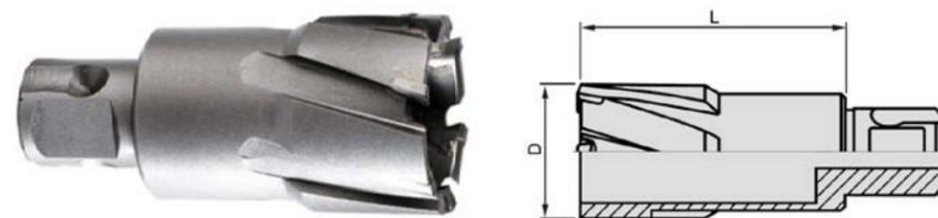
Корончатые сверла **DNTC** (бренд CNCINS) применяются для изготовления сквозных отверстий диаметром от 11 до 150 миллиметров и максимальной глубиной резания 150 миллиметров. Инструмент конструктивно представляет собой рабочую часть в виде пустотелого цилиндра с универсальным хвостовиком. Сверло изготовлено из инструментальной стали, режущая кромка сформирована путем напайки твердосплавных пластин.
