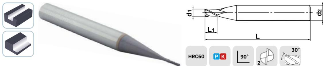
Твердосплавные микрофрезы Huareal серии **M2S...LG** используются для обработки пазов и уступов в заготовках твердостью до 60 HRC: сталь (P), чугун (K). В линейке представлены 2-зубые твердосплавные фрезы без фаски, диаметром от 0.3 до 3 мм, с углом подъема спирали 30°.
