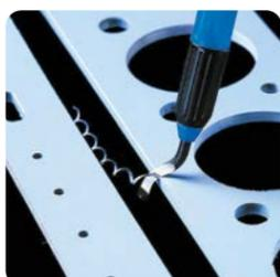
Рукоятка DT-E02000 используется для удаления заусенцев, тип применяемых сменных лезвий - серия S диаметром 3.2 мм (BS1010, DB-BK1010 и др). Инструмент изготовлен из пластика, для удобства переноски оснащен карманной клипсой. Лезвия в комплект поставки не входят и приобретаются дополнительно.
