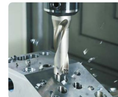
✓ Ружейные сверла (Gun drill) - специализированный металлорежущий инструмент, применяемый для изготовления глухих и сквозных отверстий большой глубины. Данный тип инструмента используется для обработки стали, нержавеющей стали, чугуна, а также цветных металлов. Конструктивно ружейное сверло состоит из хвостовика, корпуса с V-образной канавкой и каналами для СОЖ, а также цельной твердосплавной головки.
