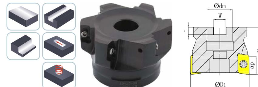
Насадные фрезы серии **ВАР** (бренд Sant) используются для торцевого фрезерования, обработки уступов и пазов с использованием твердосплавных пластин APMT1135PDER..., APMT1604PDER... В линейке представлены фрезы диаметром от 50 до 125 мм, количество зубьев от 4 до 6. Главный угол в плане 90°.
