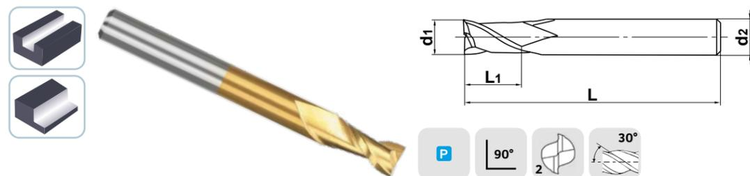
Фрезы из быстрорежущей стали Palantir серии **EMP-2F** используются для обработки пазов и уступов в заготовках из стали(P). В линейке EMP-2F представлены 2-зубые твердосплавные фрезы без защитной фаски, диаметром от 6 до 12 мм, с углом подъема спирали 30°.
