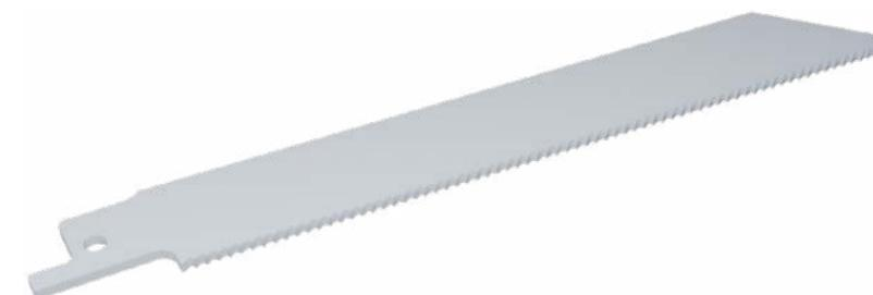
Полотна серии **RSBP** (бренд Palantir) устанавливаются в сабельную пилу и применяются для эффективной резки металла толщиной от 1/8 до 1/4 дюйма. Полотна изготовлены из биметалла с содержанием кобальта 8% и отличаются повышенной износостойкостью и устойчивостью к повышенным температурным нагрузкам. В линейке пил RSBP представлены модели с длиной от 150 до 300 мм и разным количеством зубьев на дюйм (14 tpi, 18 tpi и 24 tpi).
