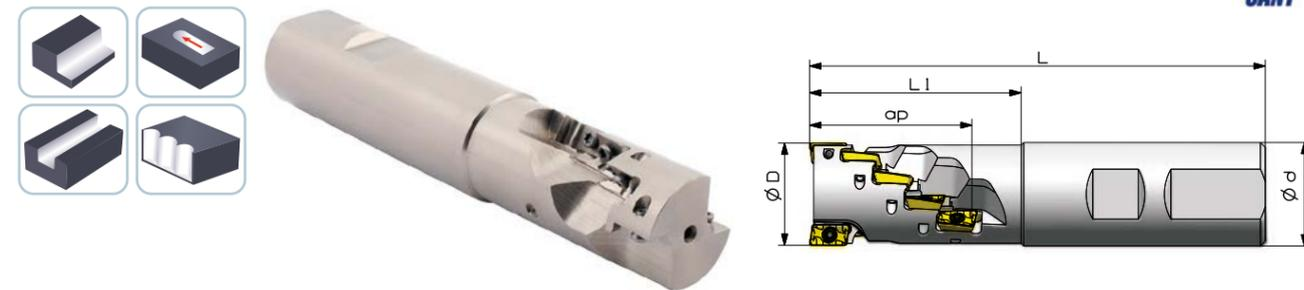
Концевые кукурузные фрезы серии **PE02** (бренд Sant) используются для торцевого, профильного фрезерования и обработки уступов с использованием твердосплавных пластин АРКТ11Т3... Корпусные фрезы PE02 обладают низкой осевой силой резания, большой глубиной резания и являются оптимальным решением для обработки тонкостенных деталей. В линейке представлены фрезы диаметром от 50 до 100 мм, количество зубьев от 4 до 6. Тип хвостовика - W (Weldon). Главный угол в плане 90°.
