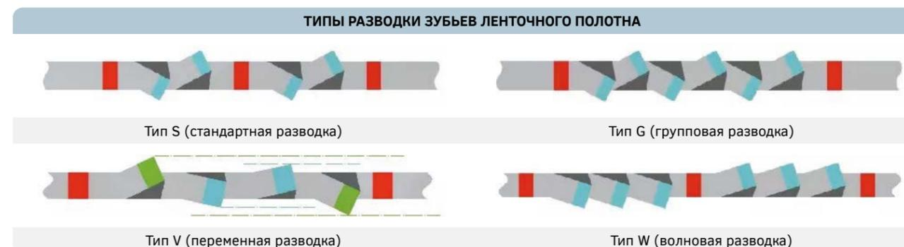
В понятие «профиль зуба» входит одновременно несколько параметров, таких как высота, передний / задний углы, радиусы скругления у основания. В биметаллических пилах по металлу применяется два профиля зуба:
