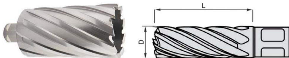
Корончатые сверла серии **DNHX** (бренд CNCINS) используются для изготовления сквозных отверстий диаметром от 12 до 100 миллиметров и максимальной глубиной резания 100 миллиметров. Инструмент изготовлен из высококачественной быстрорежущей стали (HSS). Конструктивно представляет собой рабочую часть в виде пустотелого цилиндра с хвостовиком Weldon. На рабочей части расположены стружечные канавки и режущая кромка сформированная путем заточки рабочей части.
