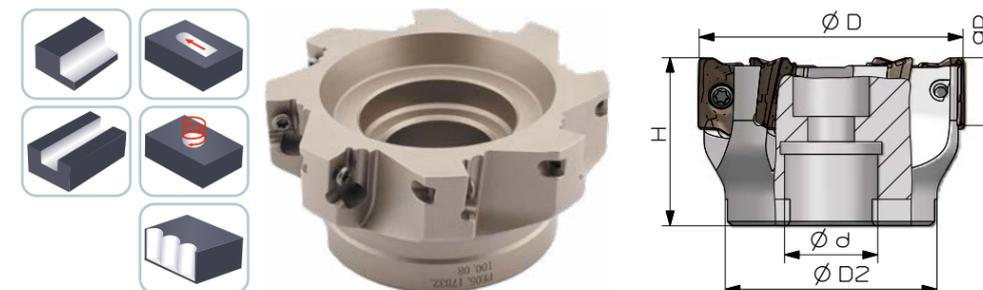
Насадные фрезы серии **PE05** (бренд Sant) используются для торцевой обработки уступов и пазов с использованием твердосплавных пластин АРКТ1705PER. Корпусные фрезы PE05 обладают низкой осевой силой резания, большой глубиной резания и являются оптимальным решением для обработки тонкостенных деталей. В линейке представлены фрезы диаметром от 40 до 200 мм, количество зубьев от 4 до 12. Главный угол в плане 90°.
