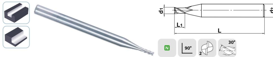
Твердосплавные микрофрезы Huareal серии **MS2...LN** (без покрытия, полированные) используются для обработки пазов и уступов в заготовках из алюминия и сплавов цветных металлов. В линейке представлены 2-зубые твердосплавные фрезы без фаски, диаметром от 0,3 до 3 мм, с углом подъема спирали 30°.
