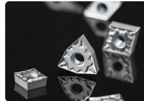
Твердосплавные пластины являются ключевым элементом токарного инструмента. Изготовленные из твердых сплавов, таких как карбид вольфрама, титана или тантала, они отличаются высокой износостойкостью и прочностью. Эти пластины устанавливаются в специальные державки и применяются для точения, растачивания и нарезания резьбы. Преимущества твердосплавных пластин включают высокую стойкость к износу, устойчивость к высоким температурам и возможность работы на высоких скоростях резания.
