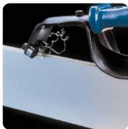
Рукоятка DT-DB1000 используется для фиксации двух сменных лезвий круглой формы серии N80 и одновременной обработки двух кромок детали. Также возможна обработка кромки внешних углов, для этого используется одно лезвие. Рукоятка оснащена защитой руки от порезов в процессе резания. Лезвия в комплект поставки не входят и приобретаются дополнительно.
