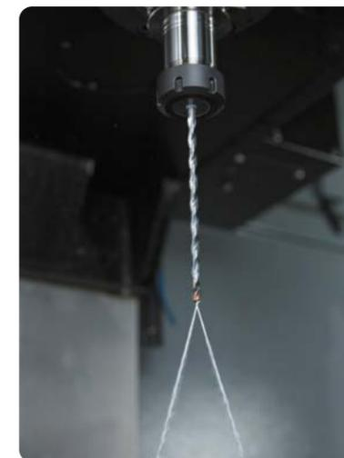
✓ Сверла твердосплавные: обладают повышенной прочностью и износостойкостью благодаря использованию специальных твердых сплавов. Применяются для сверления закаленных сталей, жаропрочных сплавов и других материалов с высокими требованиями к качеству обработки. Данная категория представлена прежде всего инструментом собственного производства (бренд CNCINS), а также несколькими сериями ряда зарубежных производителей. В каталоге представлены модели для изготовления отверстий 3XD, 5XD и 8XD.
