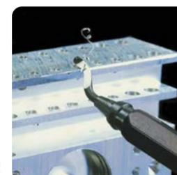
Рукоятка DT-RB1000 используется для удаления заусенцев, тип применяемых сменных лезвий - серия S диаметром 3.2 мм (BS1010, DB-BK1010 и др). Инструмент изготовлен из алюминия с нанесением защитной краски. Лезвия в комплект поставки не входят и приобретаются дополнительно.
