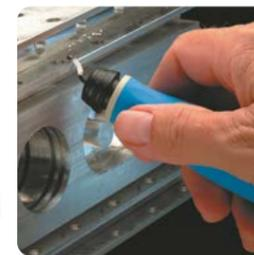
Рукоятка DT-NG1000 используется для удаления заусенцев и зенкования. Тип применяемых сменных лезвий: серия S (диаметром 3.2 мм), серия RD (RotoDrive / для зенкования). Модель оснащена вращающейся головкой с удобным механизмом фиксации лезвия. Хранение запасных лезвий осуществляется непосредственно в корпусе инструмента.
