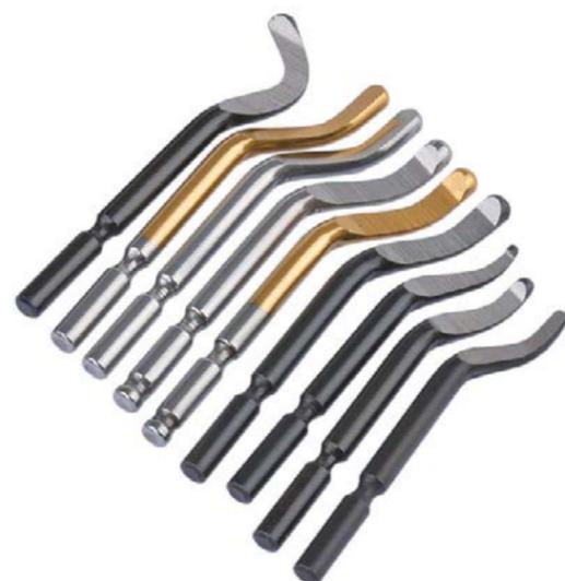
Сменные лезвия серии **DB-BS**, **DB-BK** (диаметр хвостовика 3,2 мм) используется для удаления заусенцев, выравнивания поверхностей, устранения наклепа, а также подгонки геометрии детали. Инструмент изготовлен из быстрорежущей стали с закалкой до твердости 62-64 HRC.
