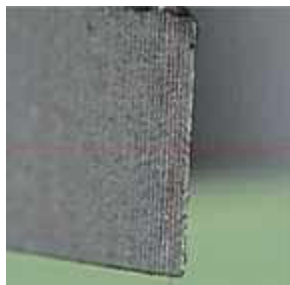
Зуб пильного полотна перед обкаткой
