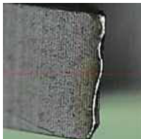
Зуб полотна после неправильной обкаткой
